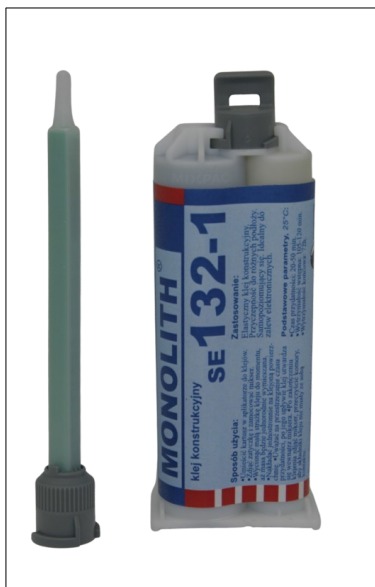
Rysunek 1: Monolith SE 132-1 - Elastyczny epoksyd o twardości ok. 70 Shore-A. Cechuje go doskonała przyczepność do wysokojakościowych blach stopowych, blach obrobionych chemicznie, blach z metali kolorowych oraz wielu tworzyw.
